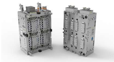
32-fach Produktionswerkzeug für Insulinpen Gehäuse
